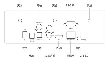
天线安装说明:请将配件中的天线安装至上图所示的天线接口。
