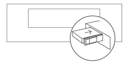
注意:请勿在设备通电的状态下装载或更换硬盘,以免造成设备或硬盘数据损坏,如果是全新硬盘,请先格式化硬盘再装载至设备,本机支持硬盘格式为: EXT3、EXT4、NTFS、FAT32、EXFAT。
