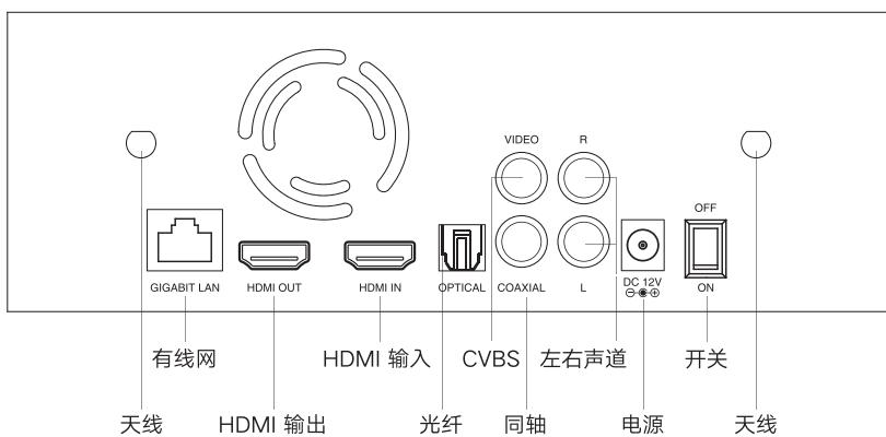
天线安装说明：请将附件中的两根天线安装至上图所示的天线接口。
